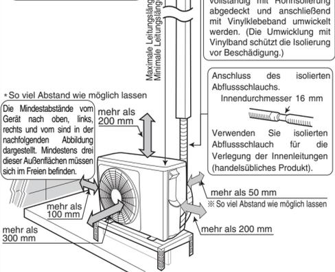
Bei der Installation des Außengeräts muss an mindestens zwei Seiten des Geräts ausreichend Raum für die gute Luftzirkulation bleiben.
